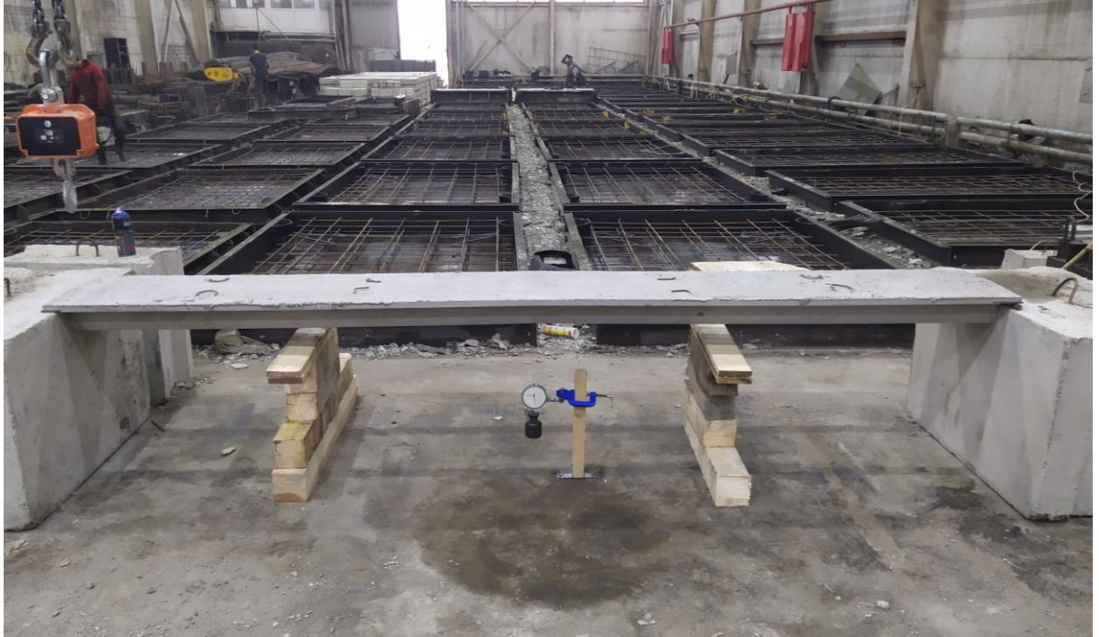
Рисунок 2 – Плита несъемной опалубки перед испытанием
