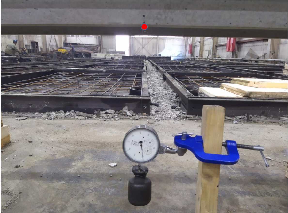
Рисунок 5 – Место крепления прогибомера
