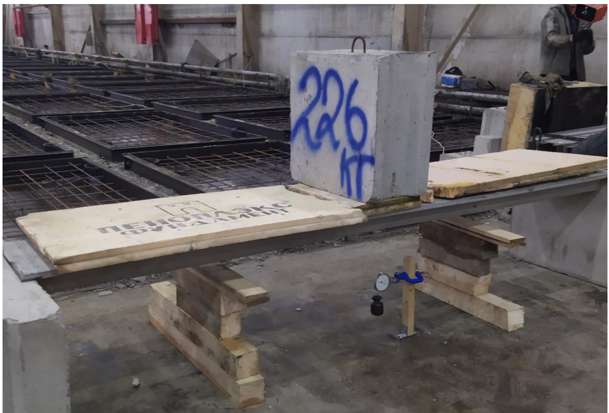
Рисунок 6 – Первый этап нагружения
