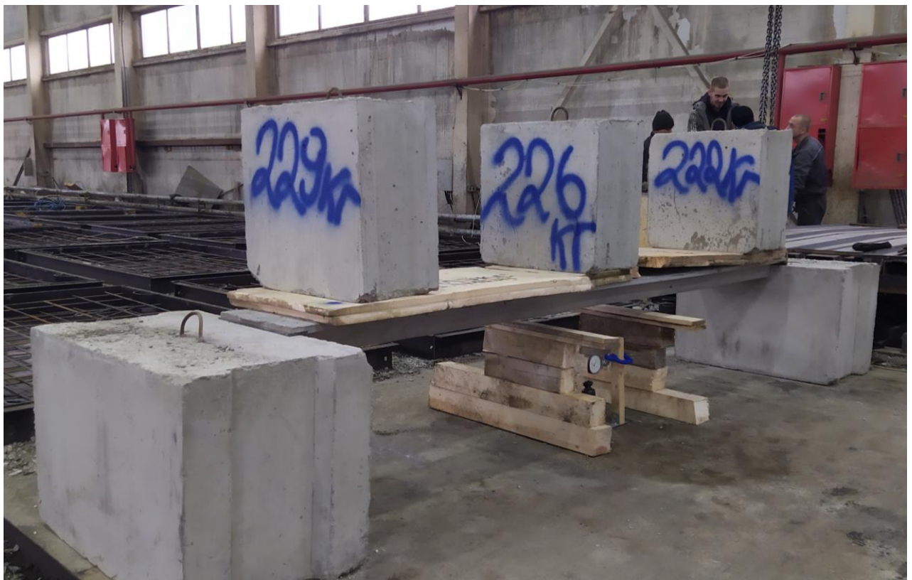
Рисунок 8 – Третий этап нагружения
