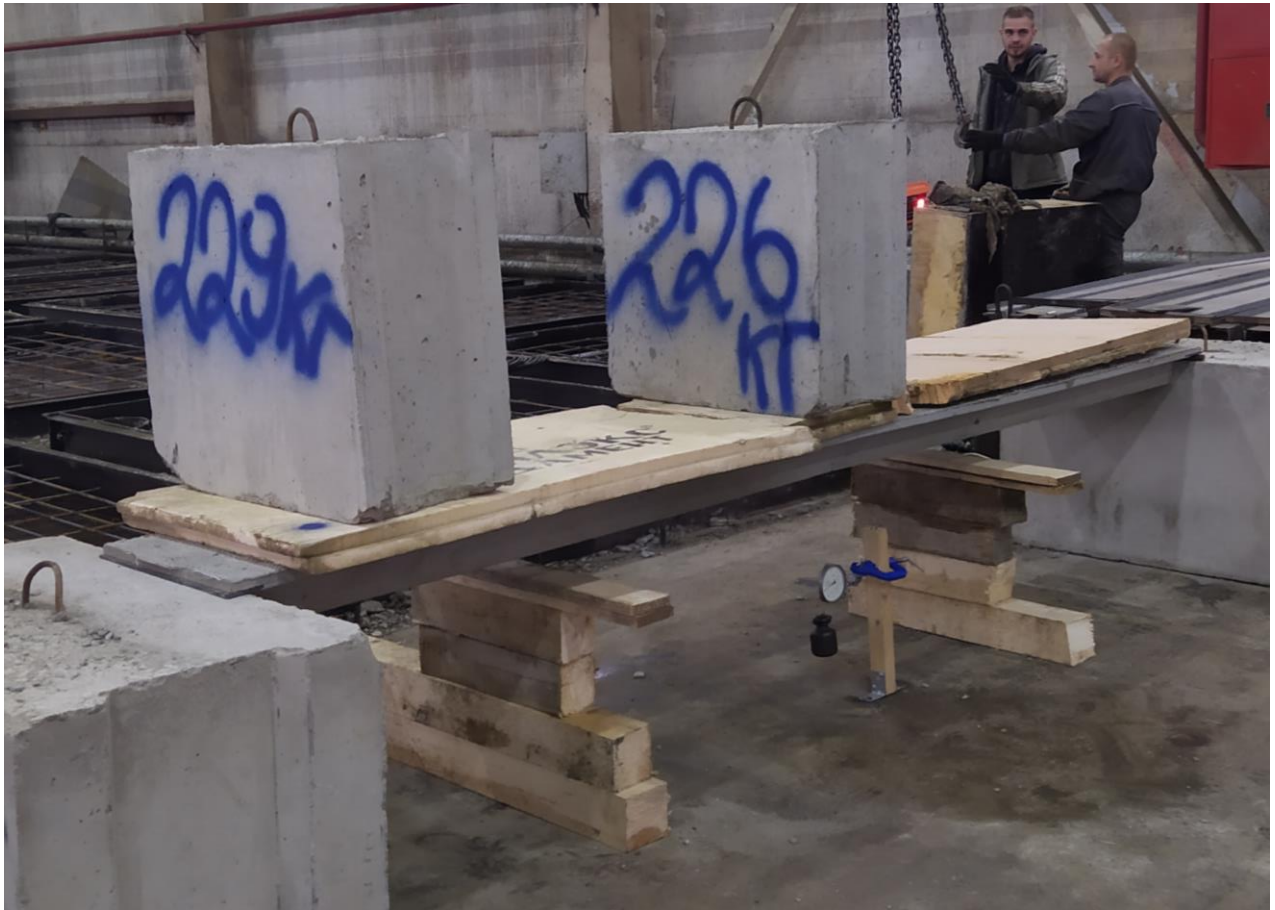
Рисунок 7 – Второй этап нагружения
